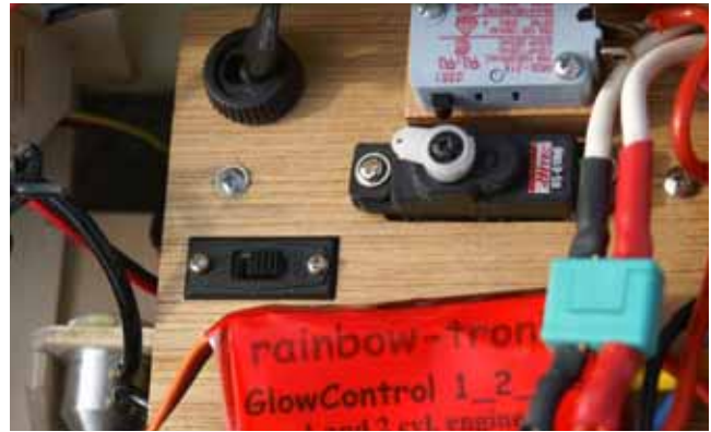
Die Abb. zeigt das IC-Servo und den Microschalter, der zum Ein- und Ausschalten des Anlassmotors verwendet wird.
